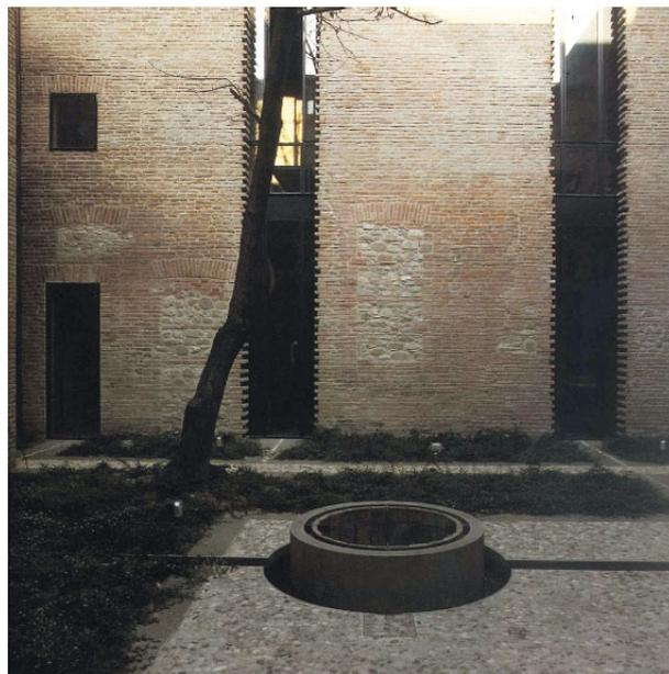
Guido Canali, restauro delle ex-carceri, Sassuolo: i nuovi sistemi di collegamento verticale e di delimitazione degli ambienti inseriti nell'esistente sono nettamente distinti da esso mediante lo stacco netto tra muratura antica e nuove strutture in acciaio. I tagli nella muratura sul fronte che affaccia sulla corte interna segnalano l'intervento contemporaneo nella trama antica
